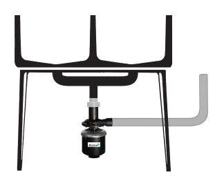
Pour une installation sur une cuve double, la pompe doit être centrée, tel qu'illustré ci-contre.
